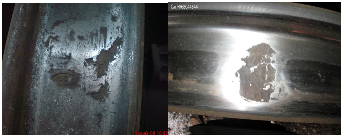
Рисунок 3.18 – Дефекти на поверхні катання коліс
