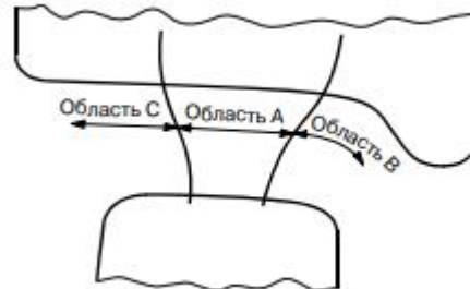
Рисунок 1.4 – Розподіл контакту колеса та рейки на функціональні області
